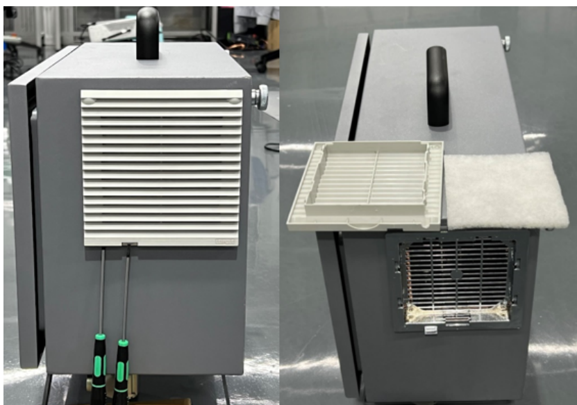
图 2-3: 控制柜过滤器拆装
