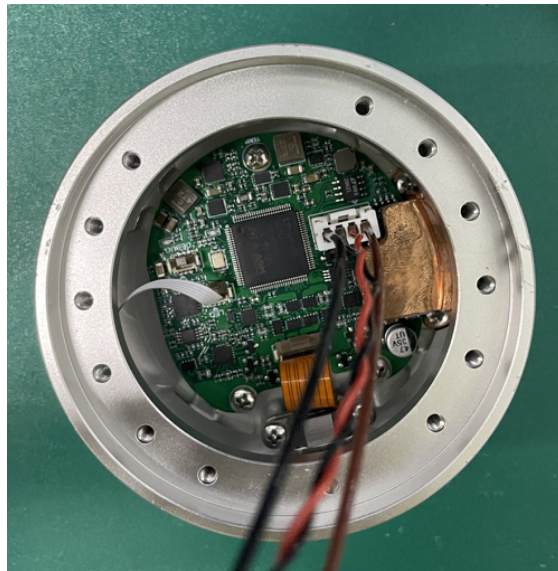
图 3-16: 连接手腕 3 关节和末端法兰的电线
