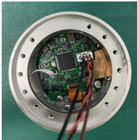
图 3-16: 连接手腕 3 关节和末端法兰的电线
