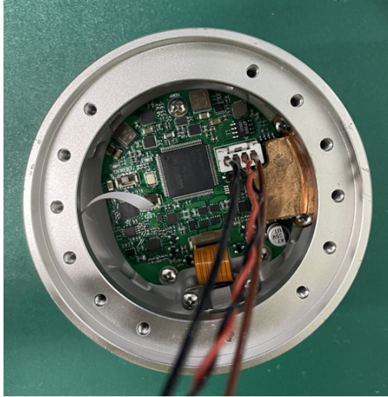
图 3-16: 连接手腕 3 关节和末端法兰的电线
