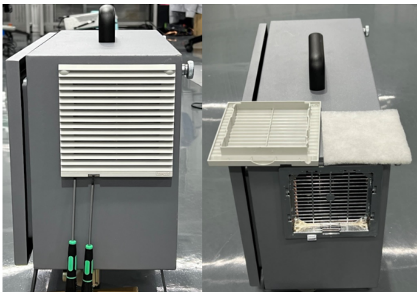
图 2-3: 控制柜过滤器拆装
