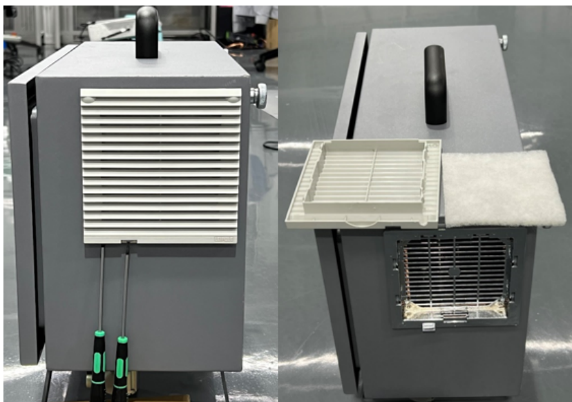
图 2-3: 控制柜过滤器拆装
