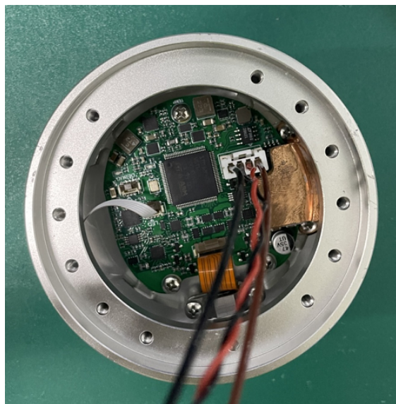
图 3-16: 连接手腕 2 关节和末端法兰的电线
