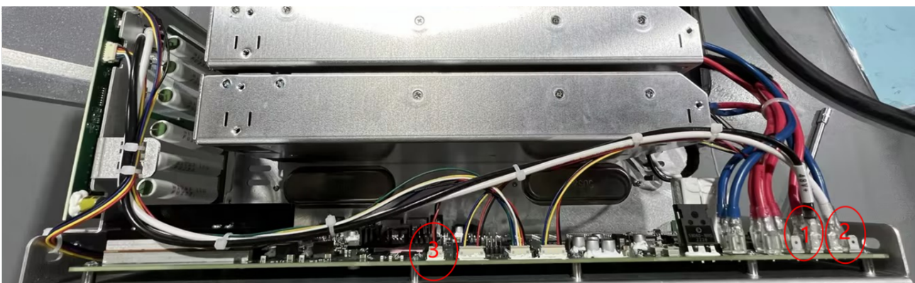
图 3-27: Safe I/O 上的线缆位置
