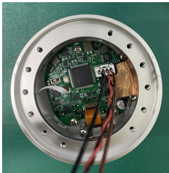
图 3-16: 连接手腕 2 关节和末端法兰的电线
