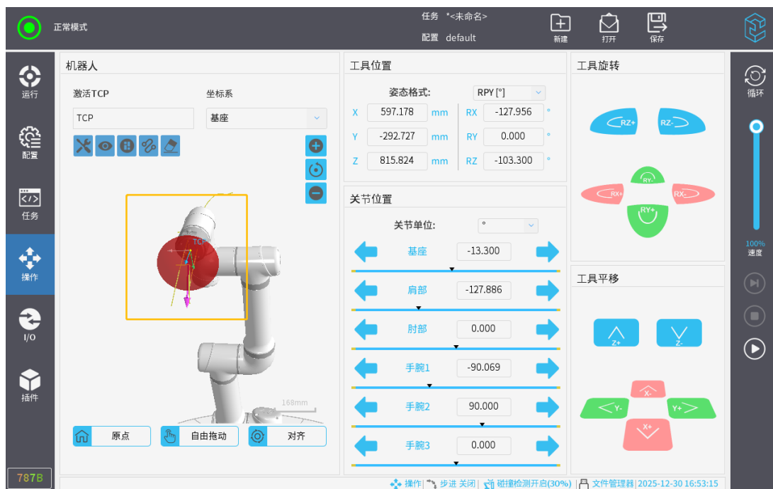
图 3-85: 工具方向模型红色提示
