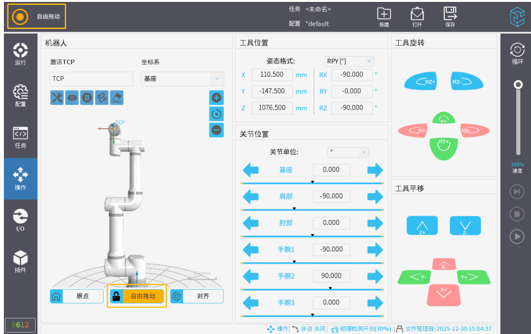
图 3-158: 自由拖动锁定（非锁轴拖动模式下）
