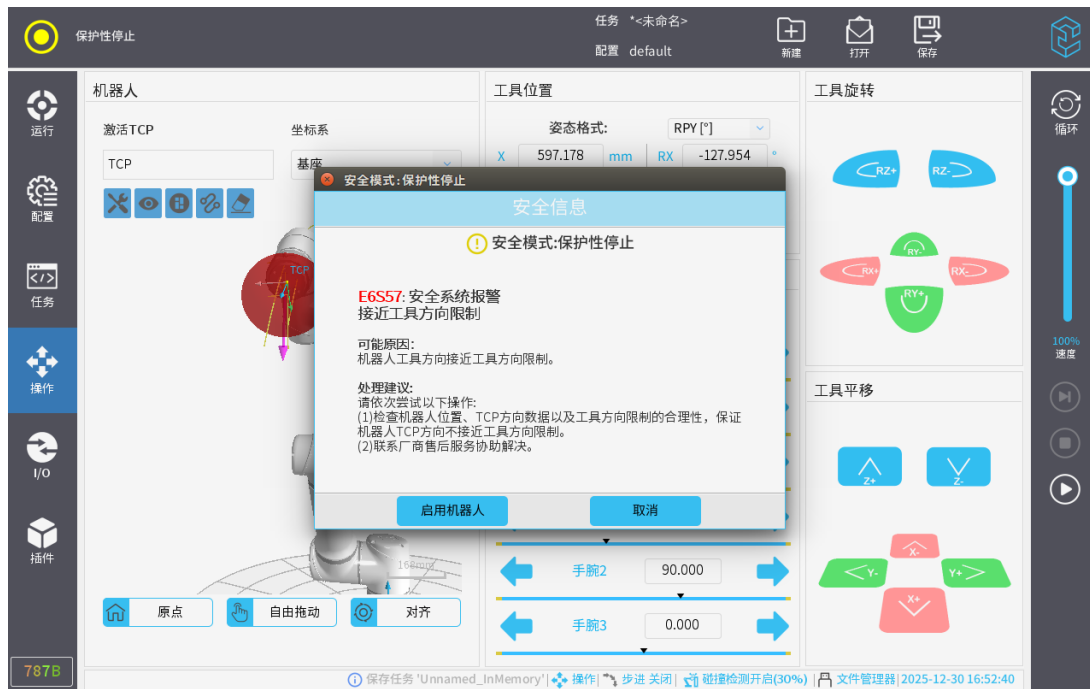
图 3-86: 安全系统报警 (接近工具方向限制)
