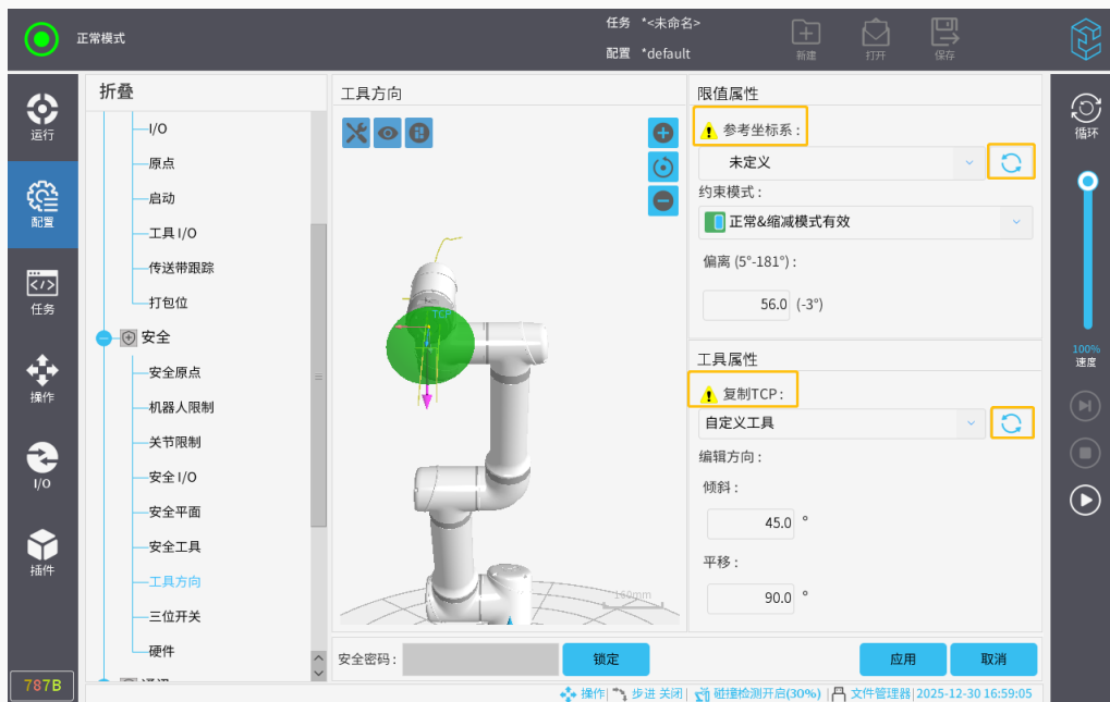
图 3-89: 工具方向界面（坐标系和 TCP 修改后）
