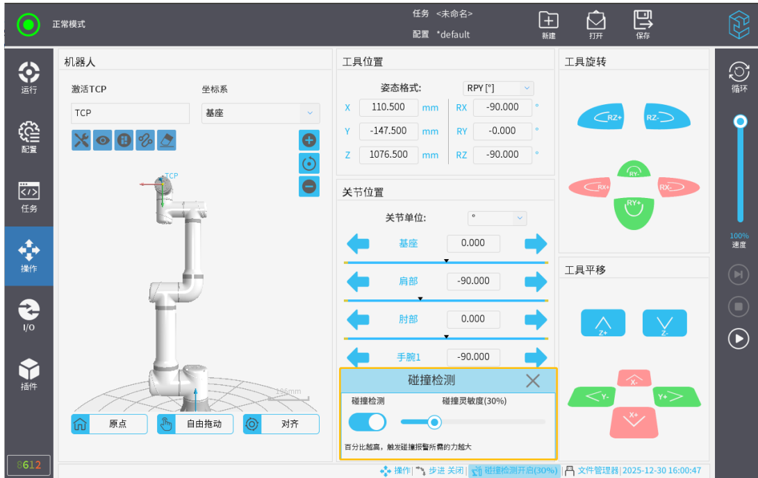
图 3-13: 开启碰撞检测
