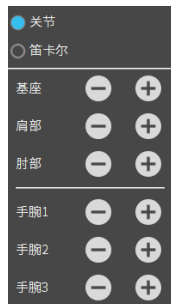
图 2-36: 轴运动控制按键（关节）
