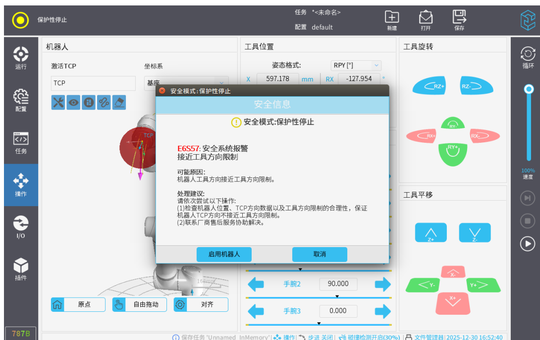
图 3-86: 安全系统报警（接近工具方向限制）
