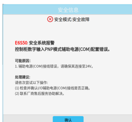
图 2-15: 安全系统报警（PNP）
