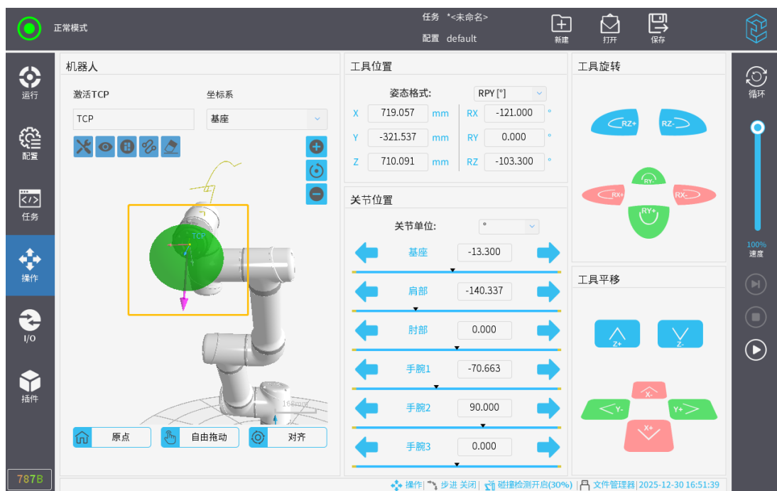
图 3-84: 工具方向模型绿色提示
