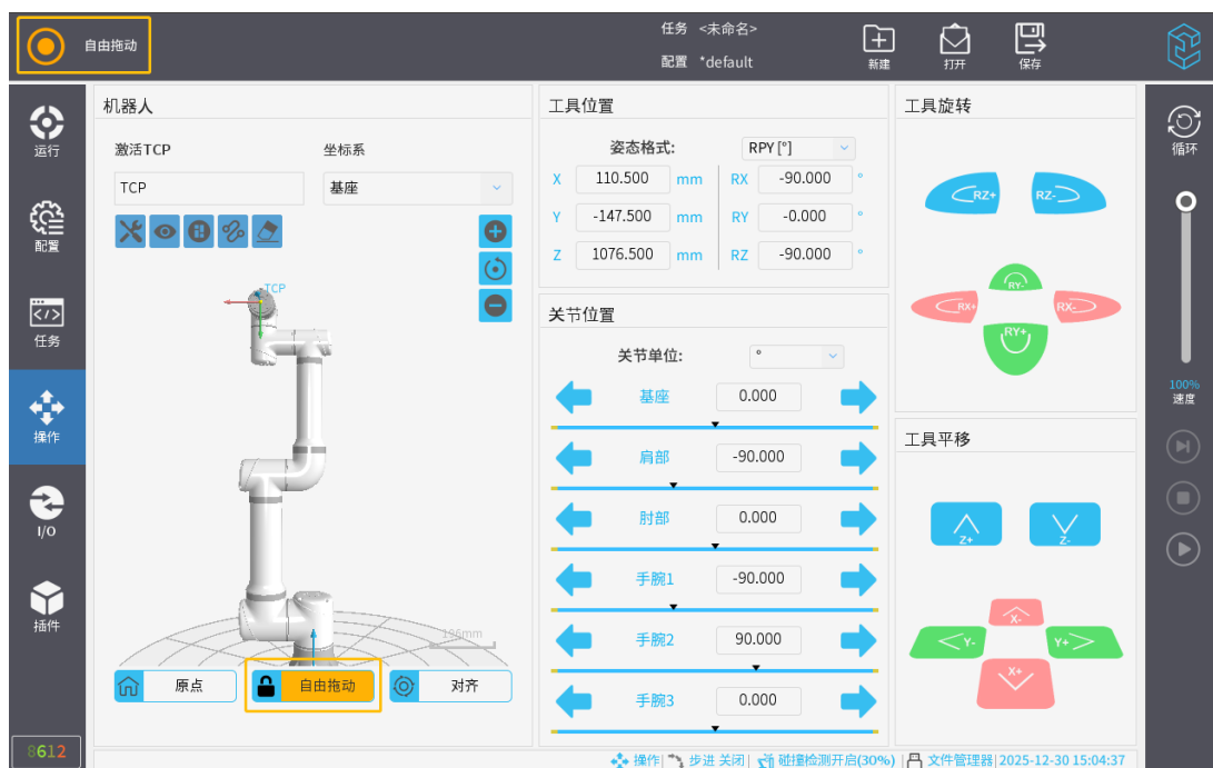
图 3-158: 自由拖动锁定（非锁轴拖动模式下）
