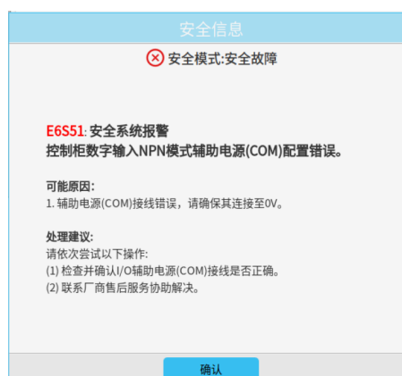
图 2-16: 安全系统报警（NPN）
