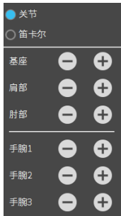
图 2-36: 轴运动控制按键（关节）
