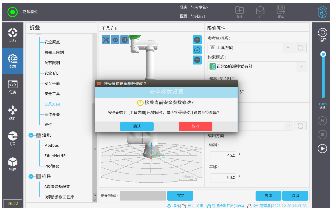
图 3-83: 应用工具方向的配置
