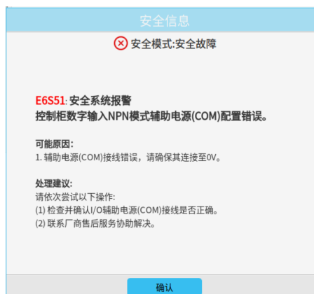
图 2-16: 安全系统报警 (NPN)
