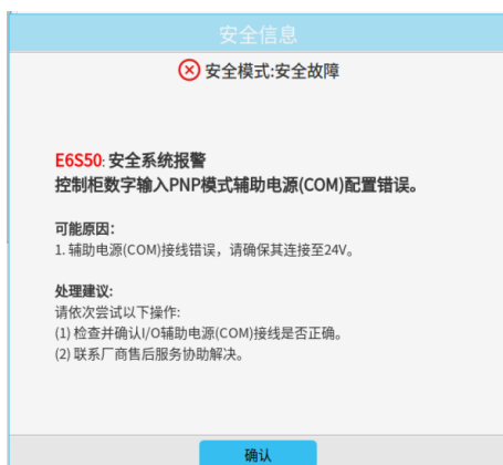
图 2-15: 安全系统报警 (PNP)
