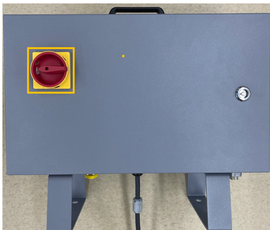
图 4-7：控制箱正面的电源开关
