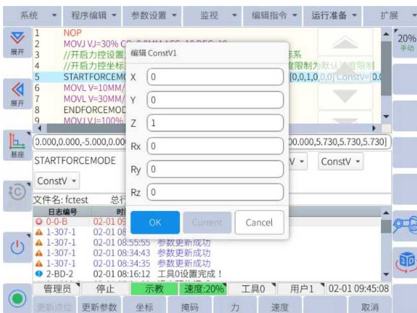
图 6-50: 掩码界面自由度的掩码设置
