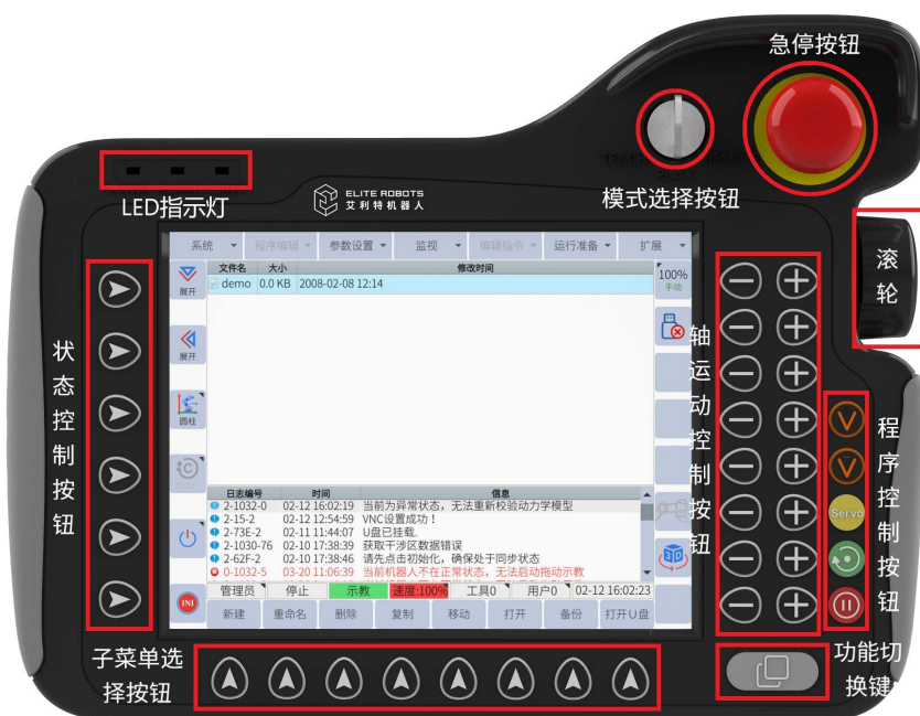
图 6-1：示教器布局（正面）
