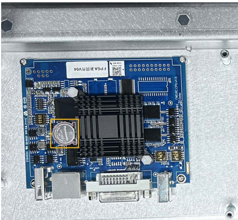
图 5-7：电池安装完成
