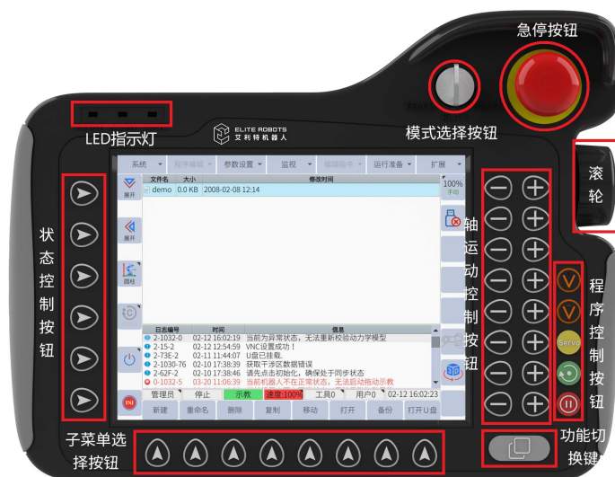
图 3-11：示教器布局（正面）
