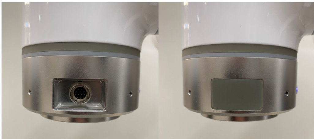
图 3-6：工具 I/O 插头的位置
