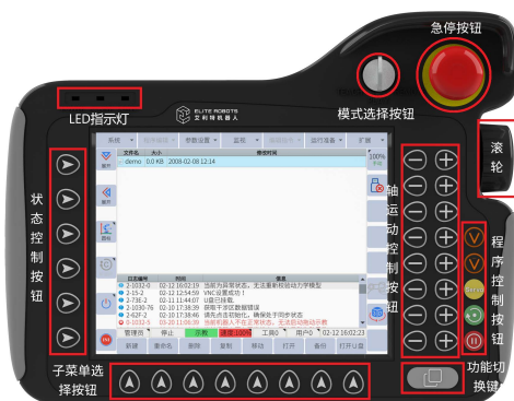
图 6-57：示教器布局（正面）
