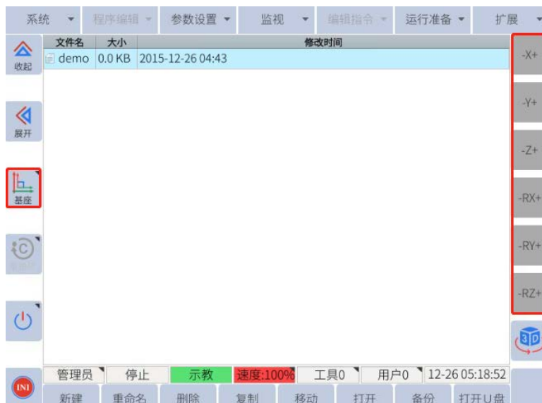
图 6-12：基座/工具/用户坐标系
