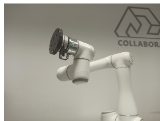
图 6-38: 负载安装完成
