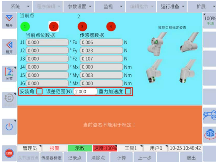
图6-44: 安装角和重力加速度
