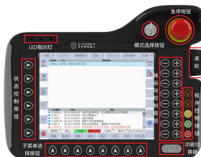
图 6-57：示教器布局（正面）
