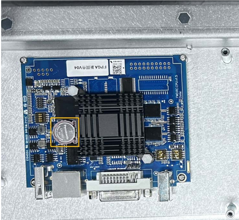
图 5-7：电池安装完成
