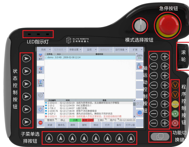
图 3-11：示教器布局（正面）
