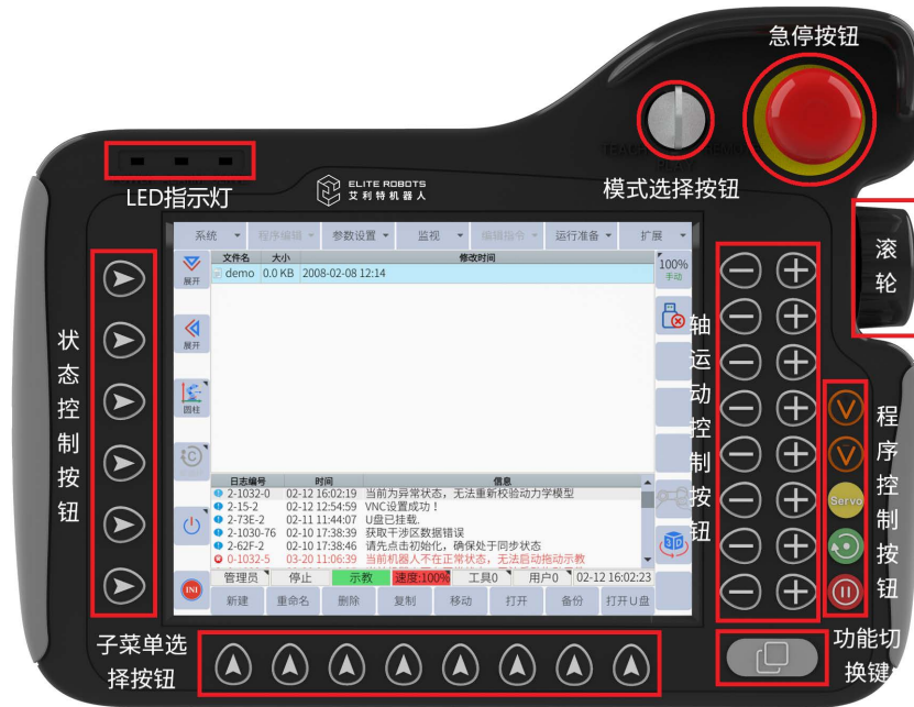
图 6-1：示教器布局（正面）
