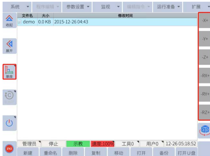
图 6-12：基座/工具/用户坐标系
