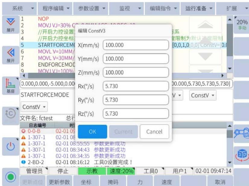
图 6-52: 设置当前力控坐标系下各力控方向的最大速度
