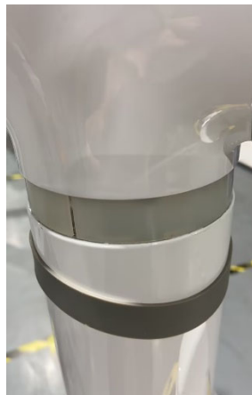
图 3-18：取下橡胶环和支撑环
