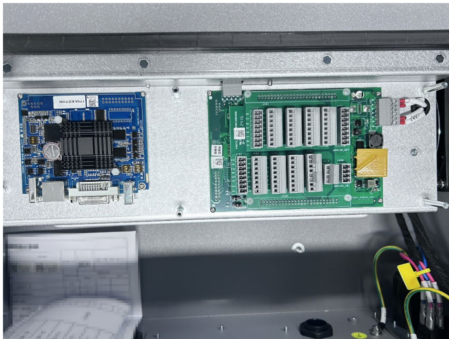
图 3-28：接口插座、通讯连接器、螺钉及网线位置
