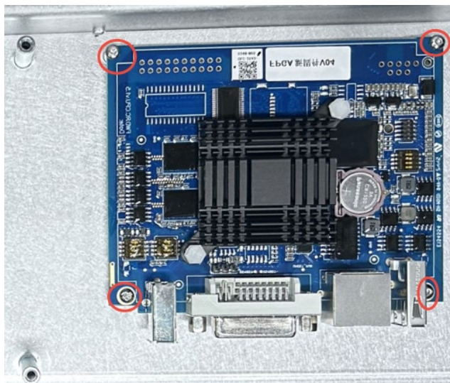
图 3-29：拆除内六角平圆头螺钉
