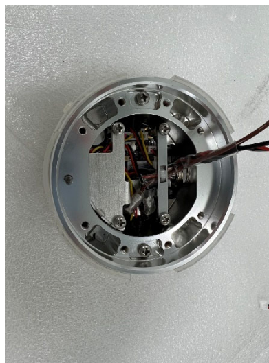
图 3-27: 连接手腕 3 关节和末端法兰的电线
