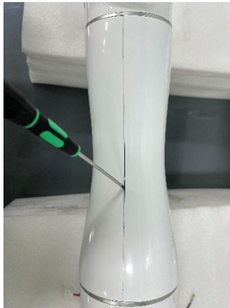
图 3-18：取下上臂橡胶环
