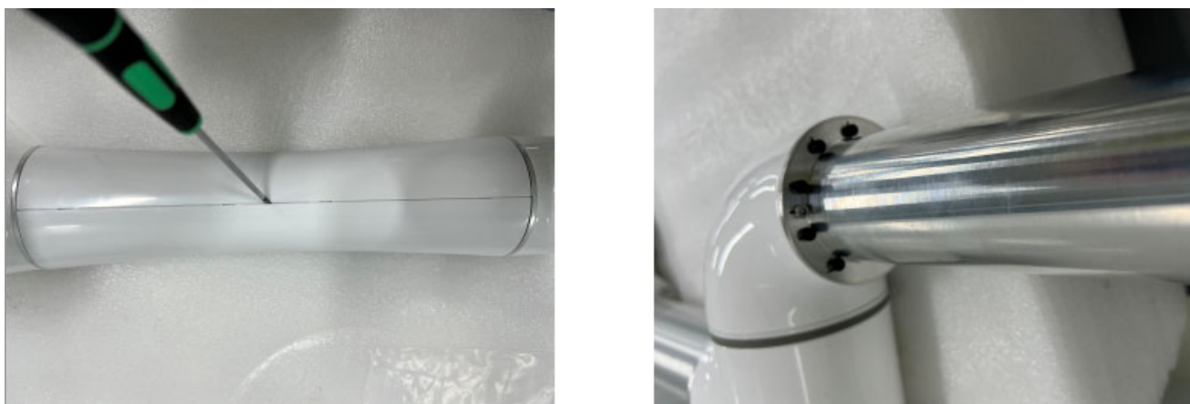
图 3-24：抽出肘部关节连接手腕 1 关节的线缆
