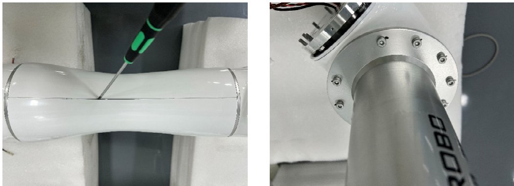
图 3-21：松开肘部关节和上臂连杆相连的内六角螺钉
