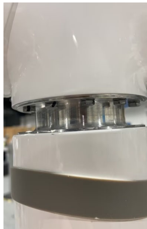
图 3-19：取下橡胶环和支撑环
