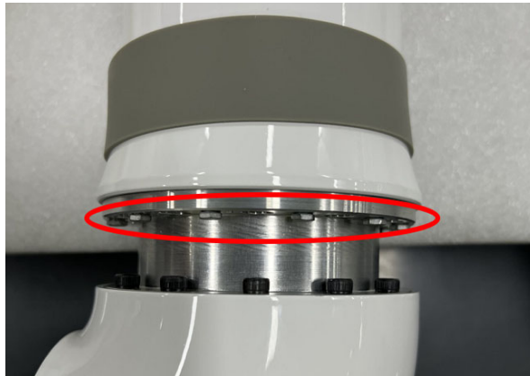
图 3-24：抽出肘部关节连接手腕 1 关节的线缆
