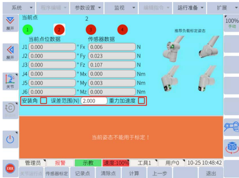
图6-44: 安装角和重力加速度
