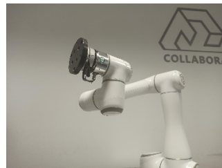
图 6-38: 负载安装完成
