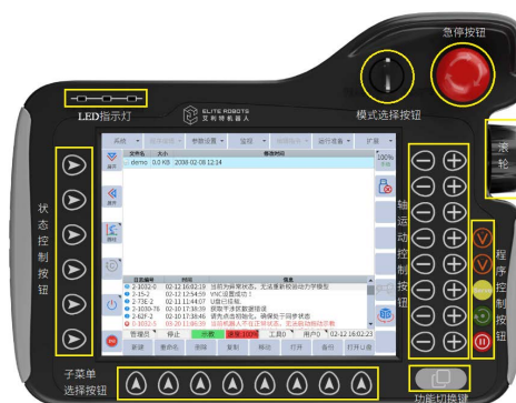
图 6-57：示教器布局（正面）
