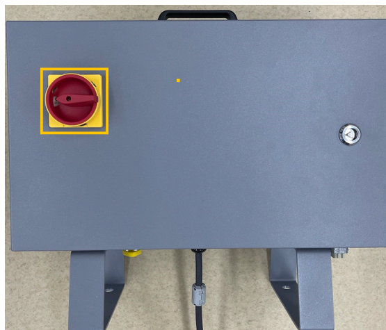
图 4-7： 控制箱正面的电源开关
