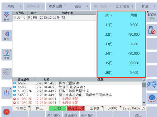
图 6-7：监视区半幅显示
