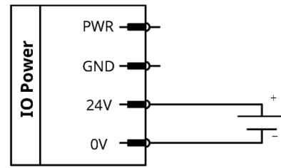
**图 2-34:** 使用外部电源接线方式
