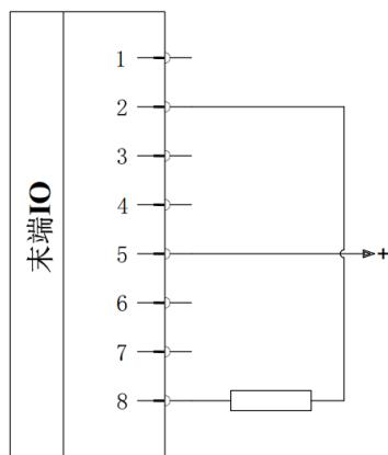
**图 2-53:** 模拟输出（非差分）连接
