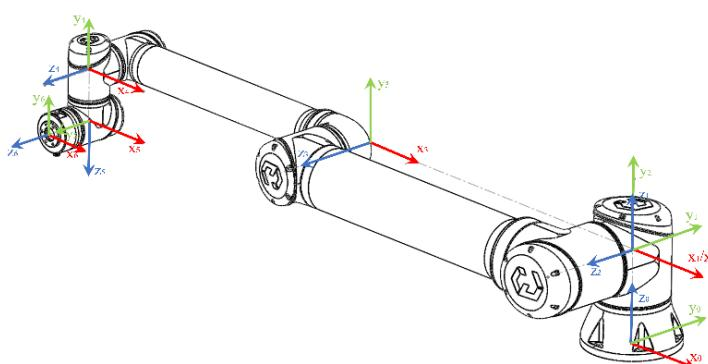
图 2-3: 机器人 DH 示意图
