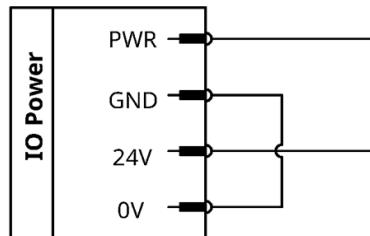
**图 2-33:** 使用内部电源接线方式
