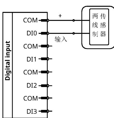
图 2-25: 数字输入 PNP 型接线 (内部供电)
