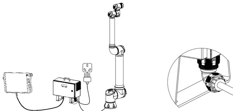
图 1-6: 整机安装-本体电缆锁定
