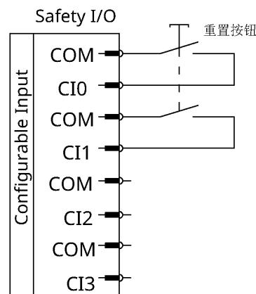
图 2-20: 控制柜的防护停止装置连接
