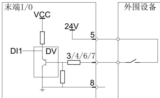
图 2-50: 工具数字输入接线方法
