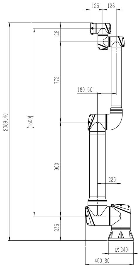
图 2-1: CS620 机器人机械尺寸图，单位 mm
