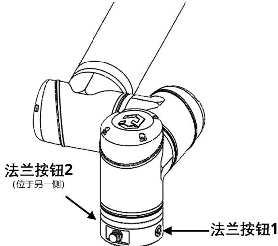
图 2-6: CS620 机器人末端法兰按钮
