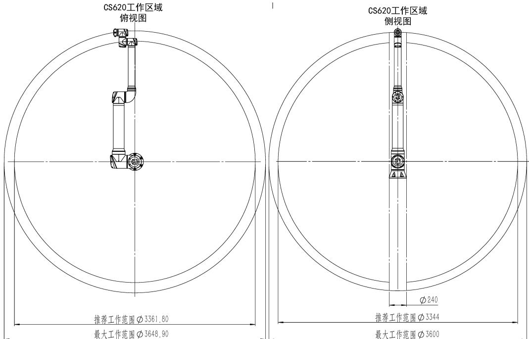
图 2-2: CS620 机器人工作空间，单位 mm
