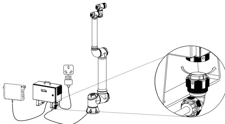
图 1-5: 整机安装-本体电缆未连接
