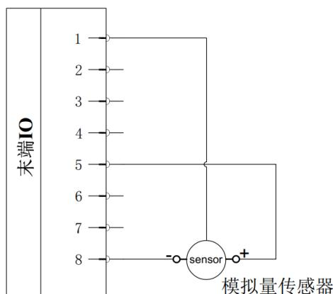
图 2-51: 模拟输入（非差分）连接
