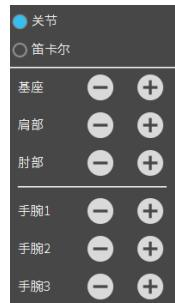
图 2-37: 轴运动控制按键（关节）
