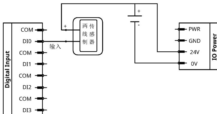
图 2-28: 数字输入 PNP 型接线 (外部供电)
