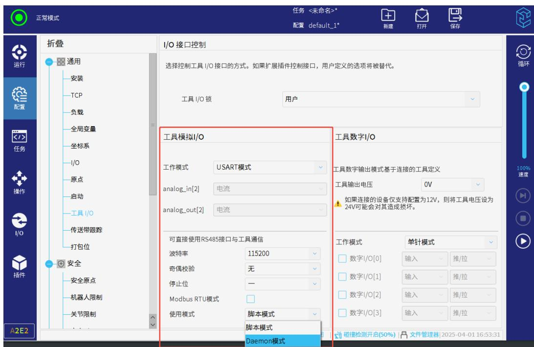
图 3-57: 工具模拟 I/O
