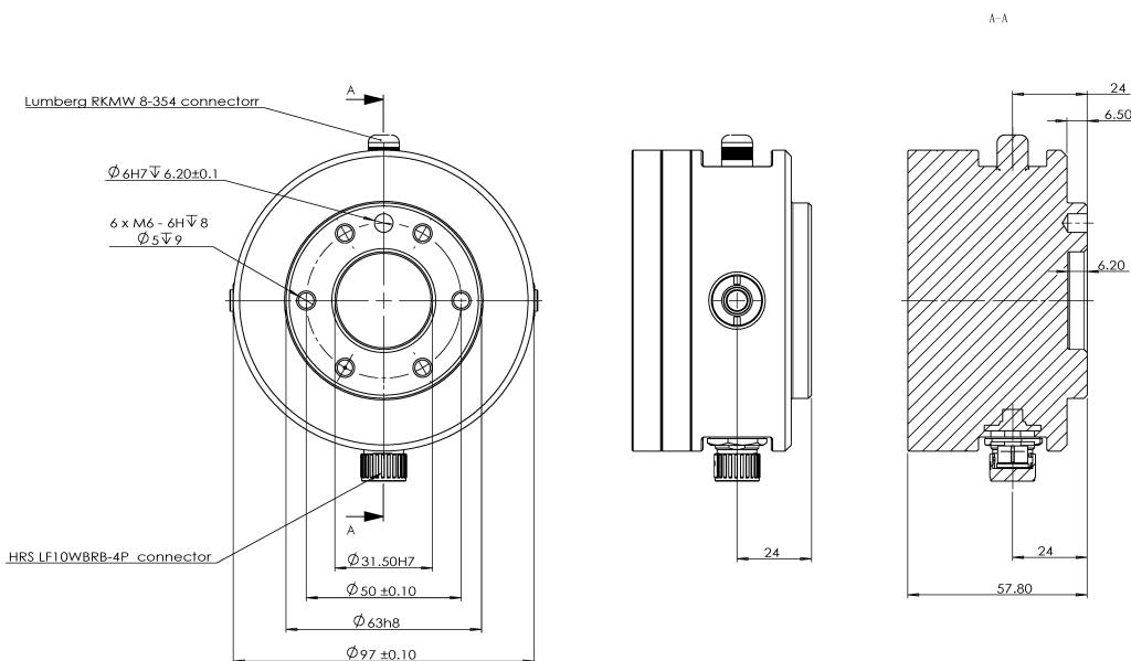
图 2-5: CS620 机器人工具法兰安装尺寸图, 单位 mm
