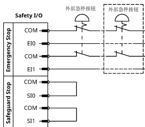
图 2-18: 安全 I/O 默认配置连接
