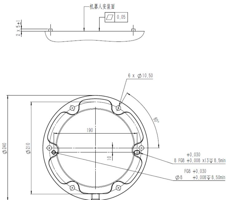
图 2-4: CS620 机器人基座安装尺寸图, 单位 mm
