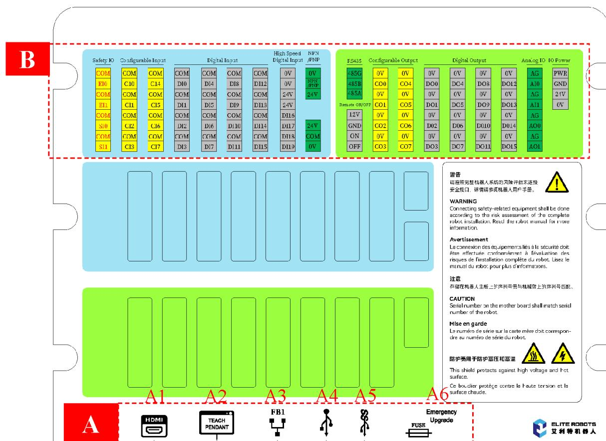
图 2-11: 控制柜内部电气接口示意图
