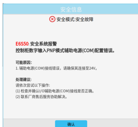
图 2-15: 安全系统报警（PNP）
