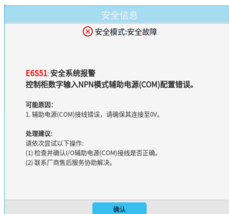
图 2-16: 安全系统报警（NPN）
