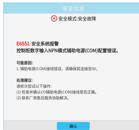
图 2-16: 安全系统报警 (NPN)
