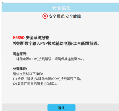
图 2-15: 安全系统报警 (PNP)
